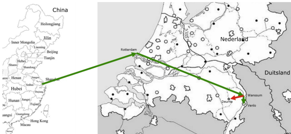
Figuur 5: Voorbeeld van een waargenomen containerketen vanuit China via Rotterdam en Wanssum naar Venlo (groen) vs een gemodelleerde reis met laatste leg van Wanssum naar Deurne
